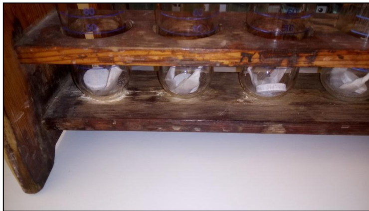
Figura 6.21 Mostres dins del tub Kjeldhal amb una pastilla de catalitzador
