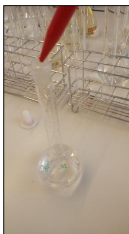
Figura 6.29 Matràs aforat omplint-se amb H 2 O destil·lada
