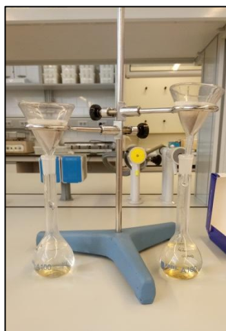
Figura 6.28 Traspàs de la solució de cendres al matràs aforat
