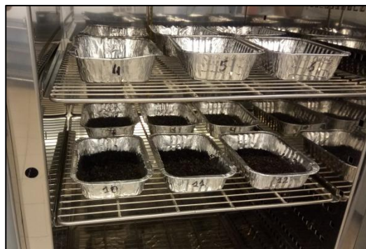
Figura 6.16 Safates amb les mostres a l'estufa a 105°C
