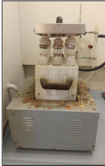
Figura 6.22 Digestor amb el col·lector de fums damunt dels tubs de Kjeldhal
