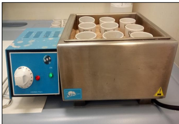
Figura 6.27 Gresols amb l'àcid nítric reduït a la meitat
