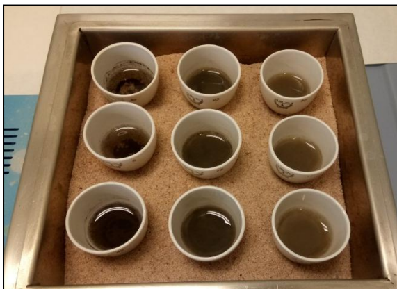
Figura 6.26 Gresols amb l'àcid nítric al bany de sorra
